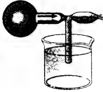
شكل 26.15 تيار من الهواء يمر أعلى أنبوبة مغموسة في سائل يجعل السائل يرتفع في الأنبوبة.
